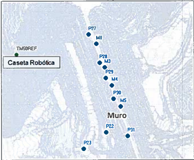
Figura 20: Ubicación caseta robótica y prismas de control topográfico
